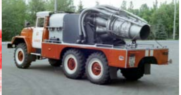
Современный АГВТ-100(131) на шасси ЗиЛ-131 харьковского производства. Фото автора
