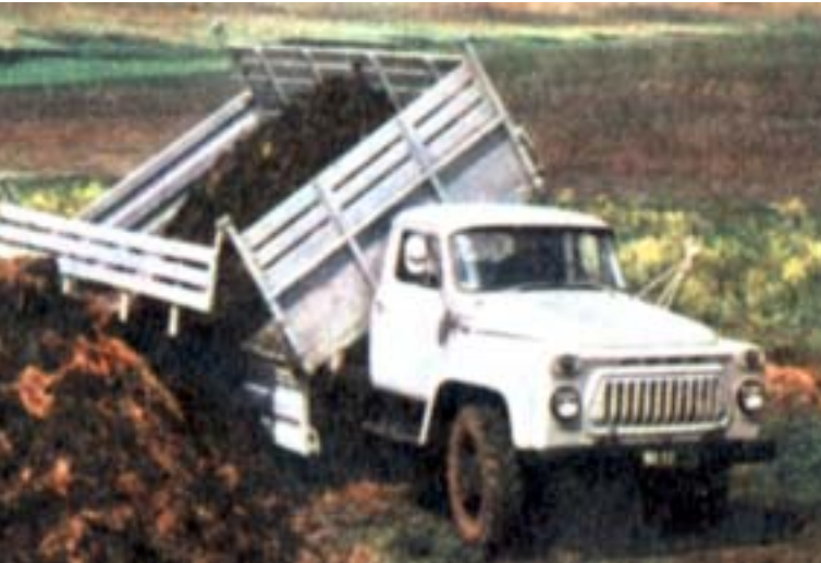
Самосвал ГАЗ-СА3-53Б с платформой старого типа (1970)
