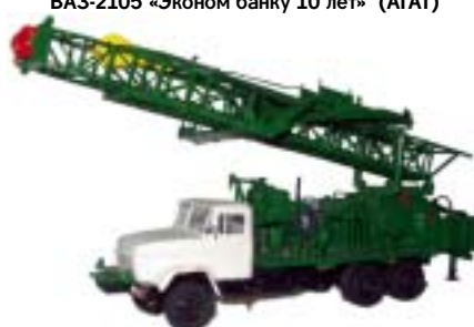
Буровая установка на шасси КрАЗ-250 (ЛОМО-АВМ, конверсия)
