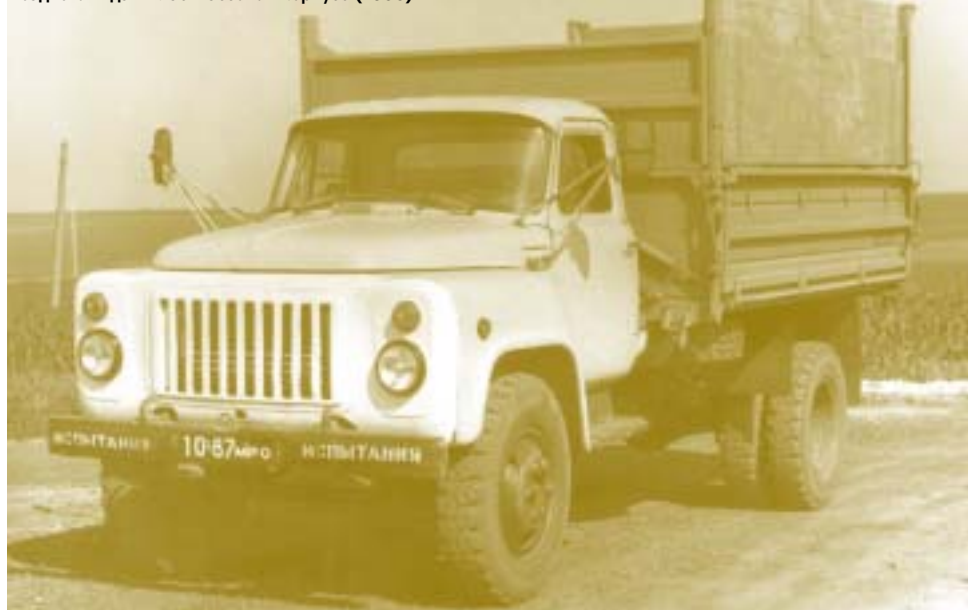
Самосвал ГАЗ-САЗ-3507 на шасси ГАЗ-53-14-01. Новая светотехника, зеркала заднего вида в пластмассовом корпусе (1988).
