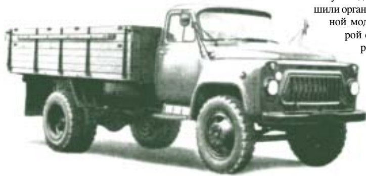
ГАЗ-53А в стандартной комплектации (1977). На крыльях – повторители указателей поворота, на облицовке – «Знак качества».
